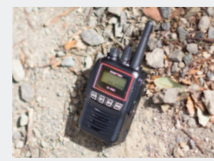
現場を想定した落下試験を実施
